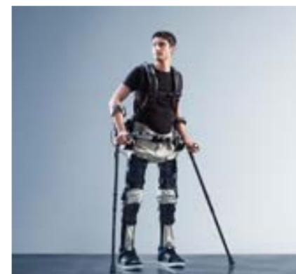
Экзоскелет eLEGS стал одним из наиболее впечатляющих изобретений XXI века. Устройство позволяет полностью парализованным людям стоять, ходить и даже подниматься по ступенькам.
