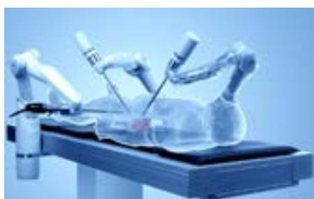
Хирургический робот представляет собой гибкий зонд с камерой высокого разрешения и хирургическими инструментами внутри. Управление осуществляется при помощи контроллера, напоминающего геймпад современных консолей.
